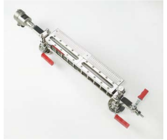
Het ouderwetse peilglas, maar dan wel voor hoge druk, uitgevoerd met een guided microwave. Er loopt een draadsonde van boven naar beneden, dwars door het peilglas, die het niveau meet.
